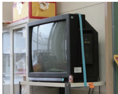
写真2. ベルトによる固定の例
