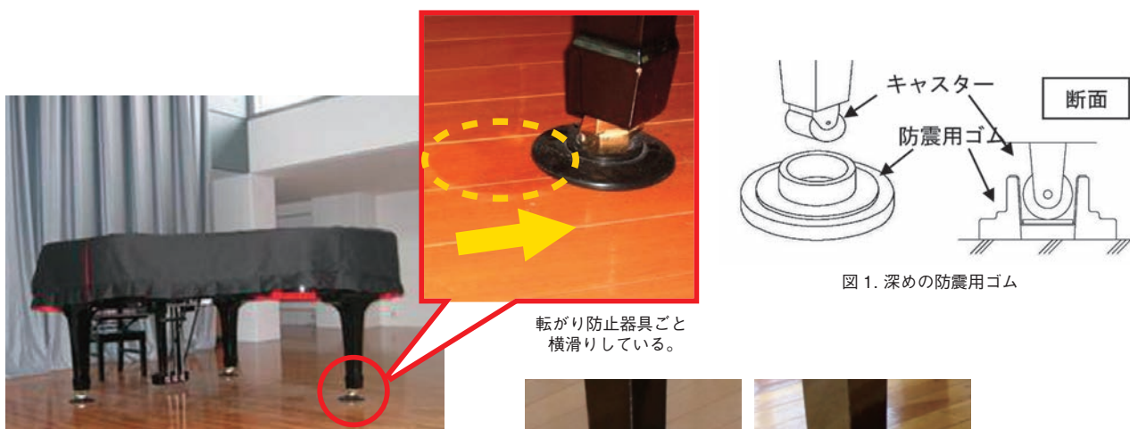
写真1. 地震の揺れによる横滑り
