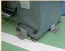
写真1. 実習用大型工作機器の耐震対策の例
