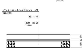
インターロッキングブロック舗装
