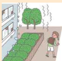
写真 1. 頭上にガラス等が落下しないための工夫（植栽の配置）の例
