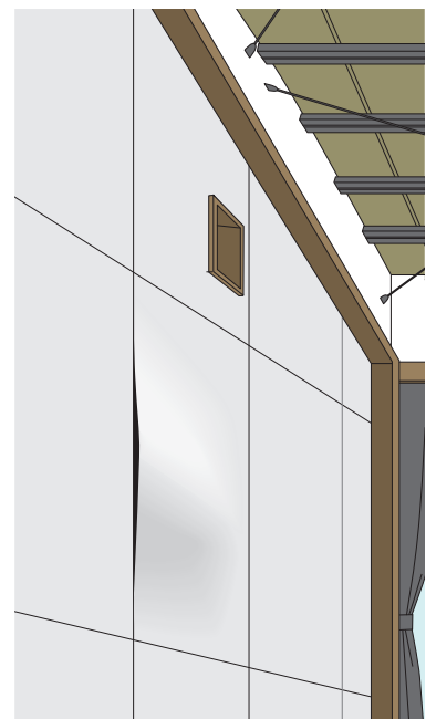
図1. 仕上げボードのはらみ（イメージ）
