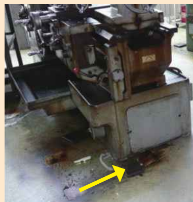
写真 2. 地震による移動の例
