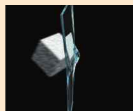
写真3. 合わせガラス…衝突時にガラス片の飛散や貫通がほとんどない。 7)
